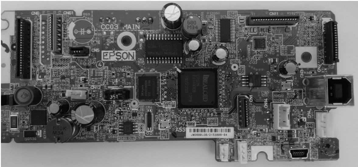
Abbildung 3: Ausgebautes Mainboard des WF-2540
